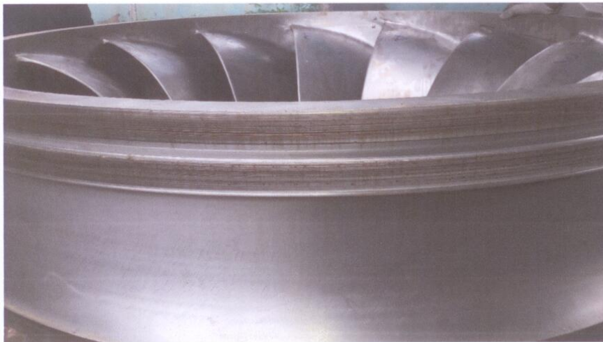
ZONA DESGASTADA EN LABERINTO Y DAÑO POR LA ARENA
