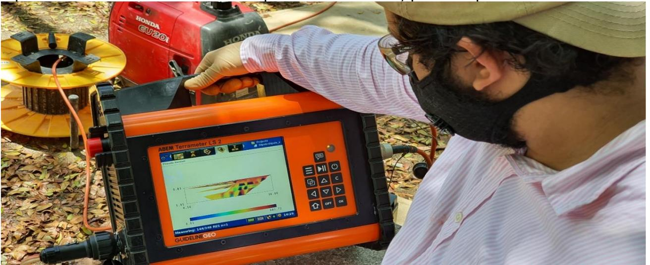
Moderno Terrameter LS 2 utilizado por Geofitec para la exploración geoelectrica del subsuelo en Pinalito.
