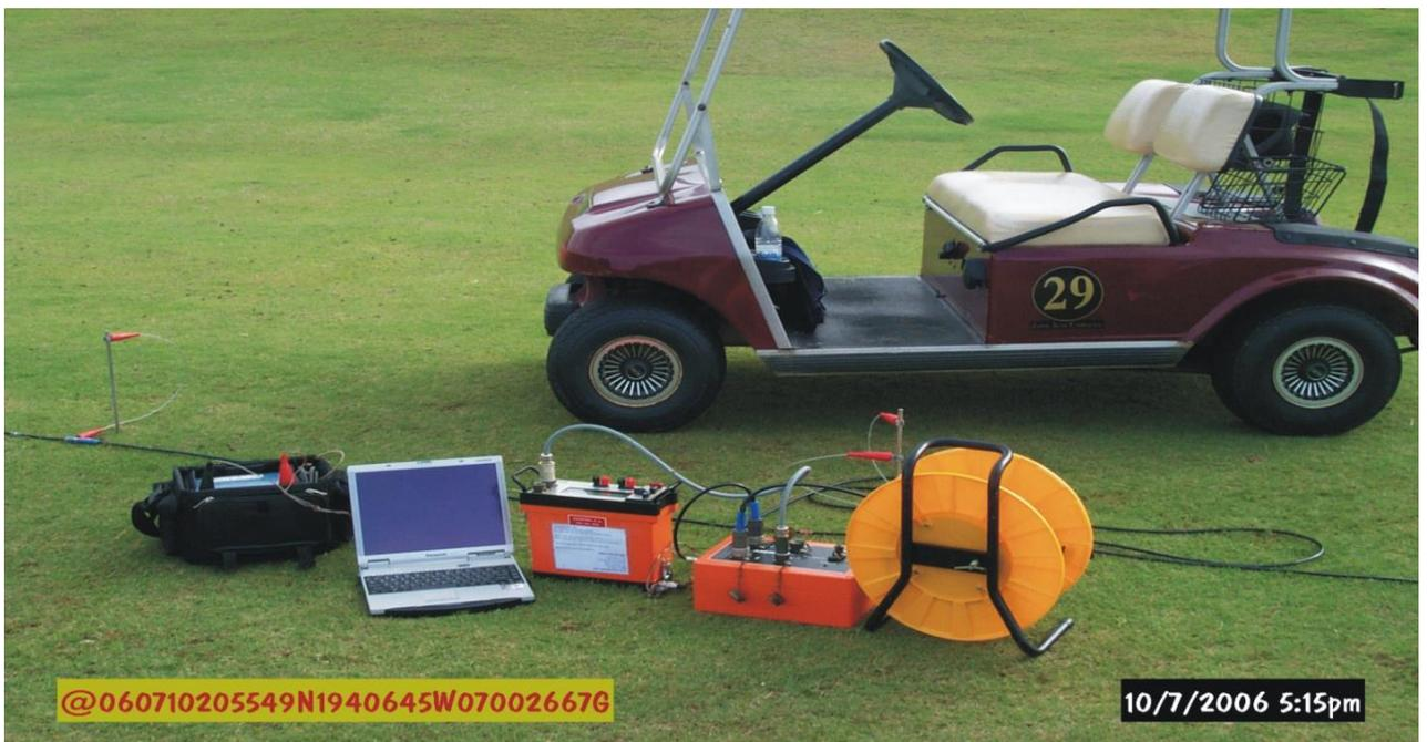
Electrodos conectados al cable coaxial y al Terrameter SAS 1000.
