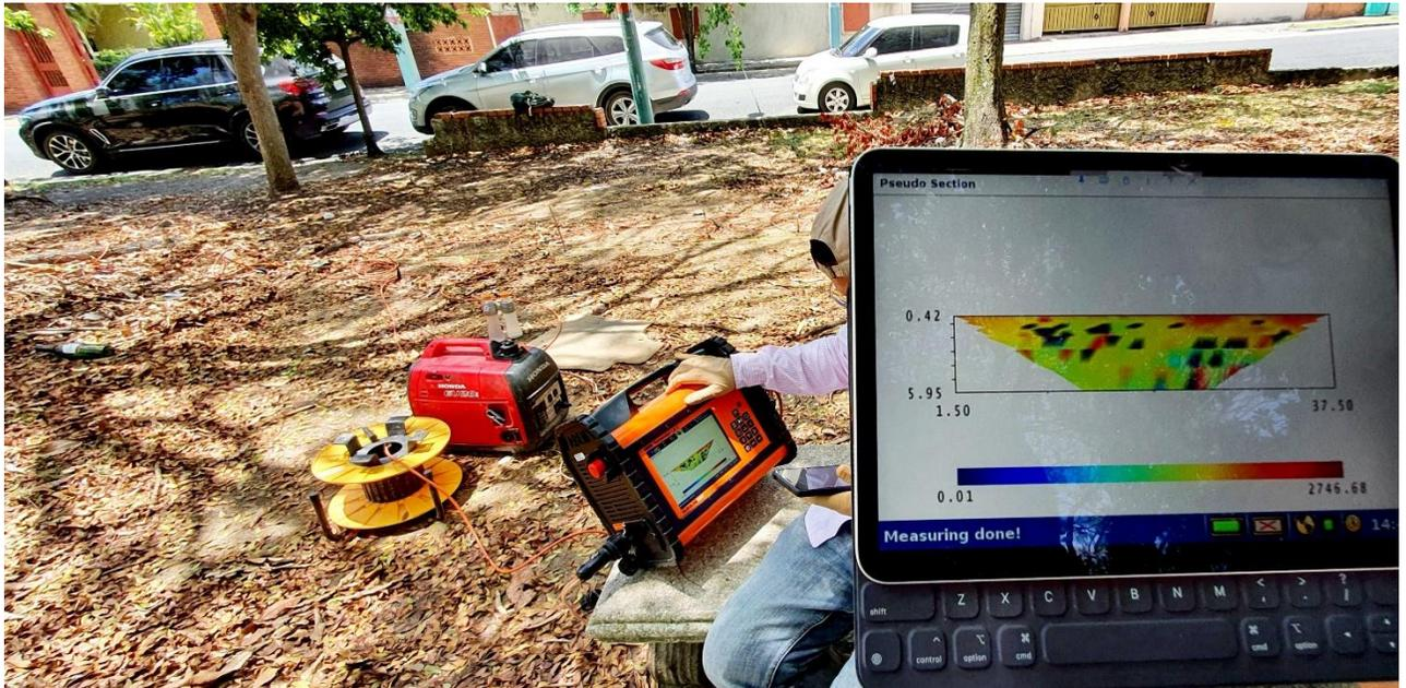
Terrameter LS 2 con múltiples electrodos para la exploración geoelectrica del subsuelo.
