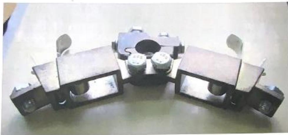
Imagen correspondiente a los porta escobillas de bronce al aluminio y presión constante antes señalados.
