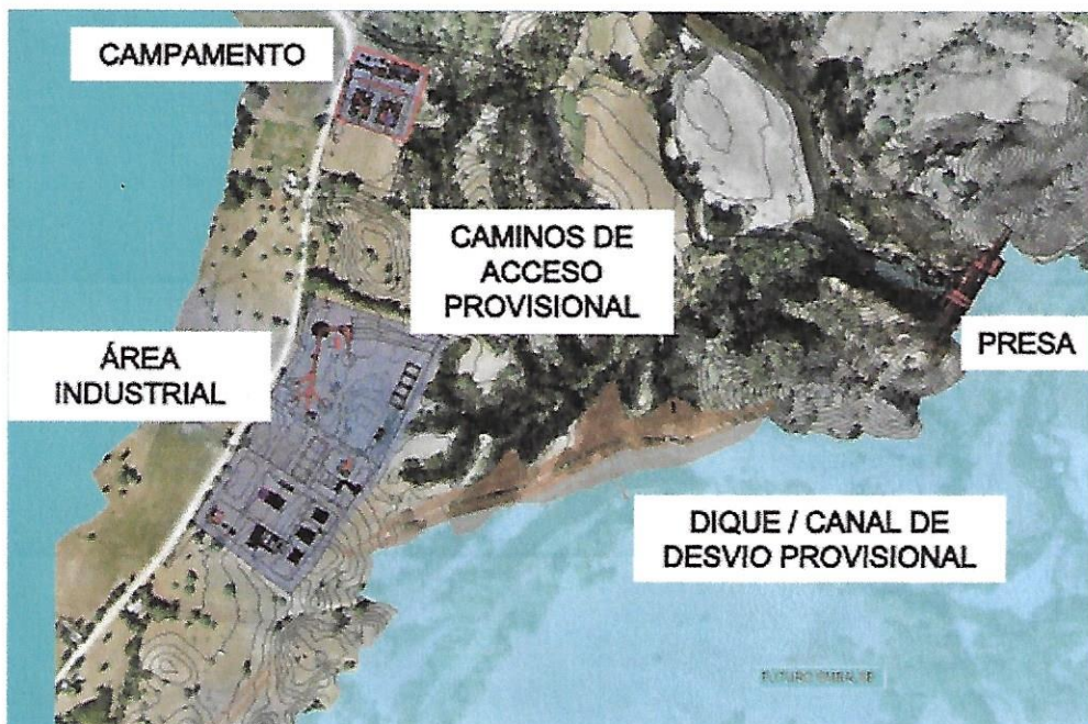
Esquema general de las Instalaciones y obras
