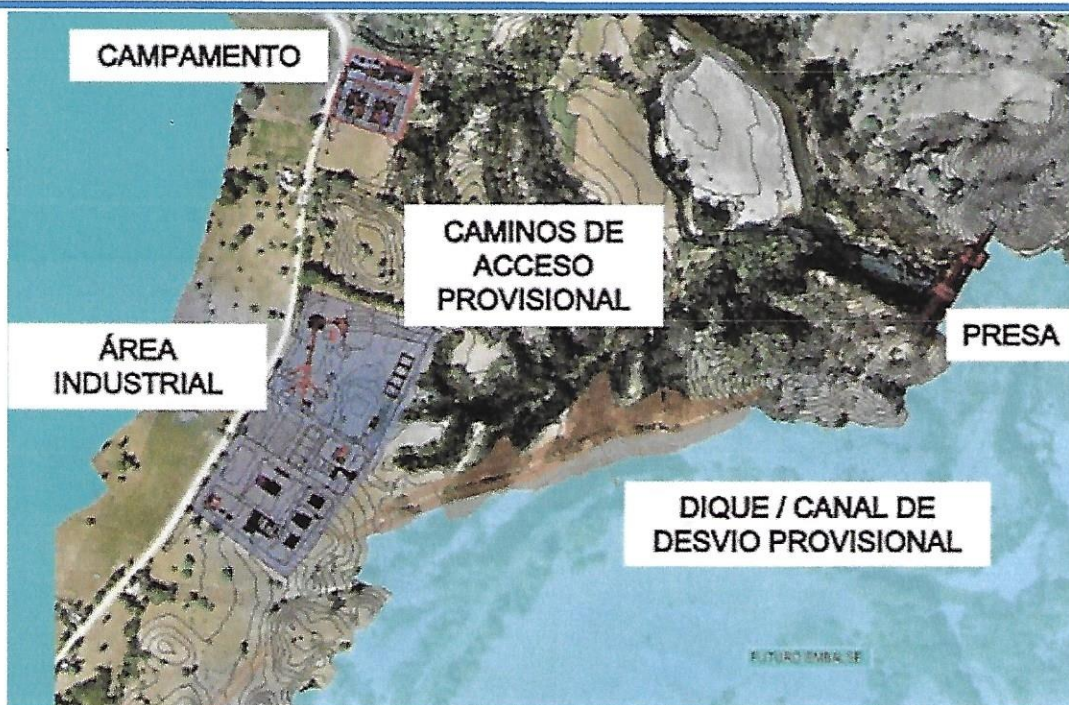
Esquema general de las Instalaciones y obras
