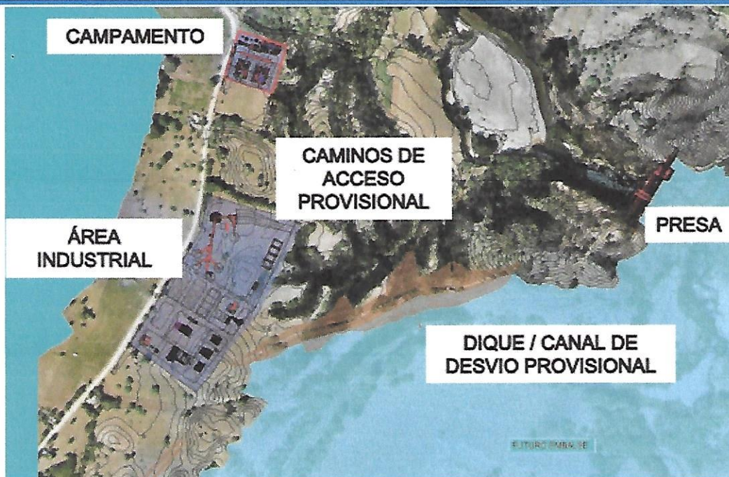
Esquema general de las Instalaciones y obras
