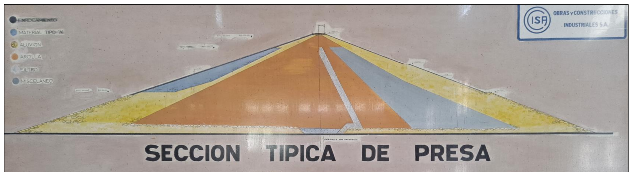
Figura N° 5. Sección tipo de la presa de Sabaneta
