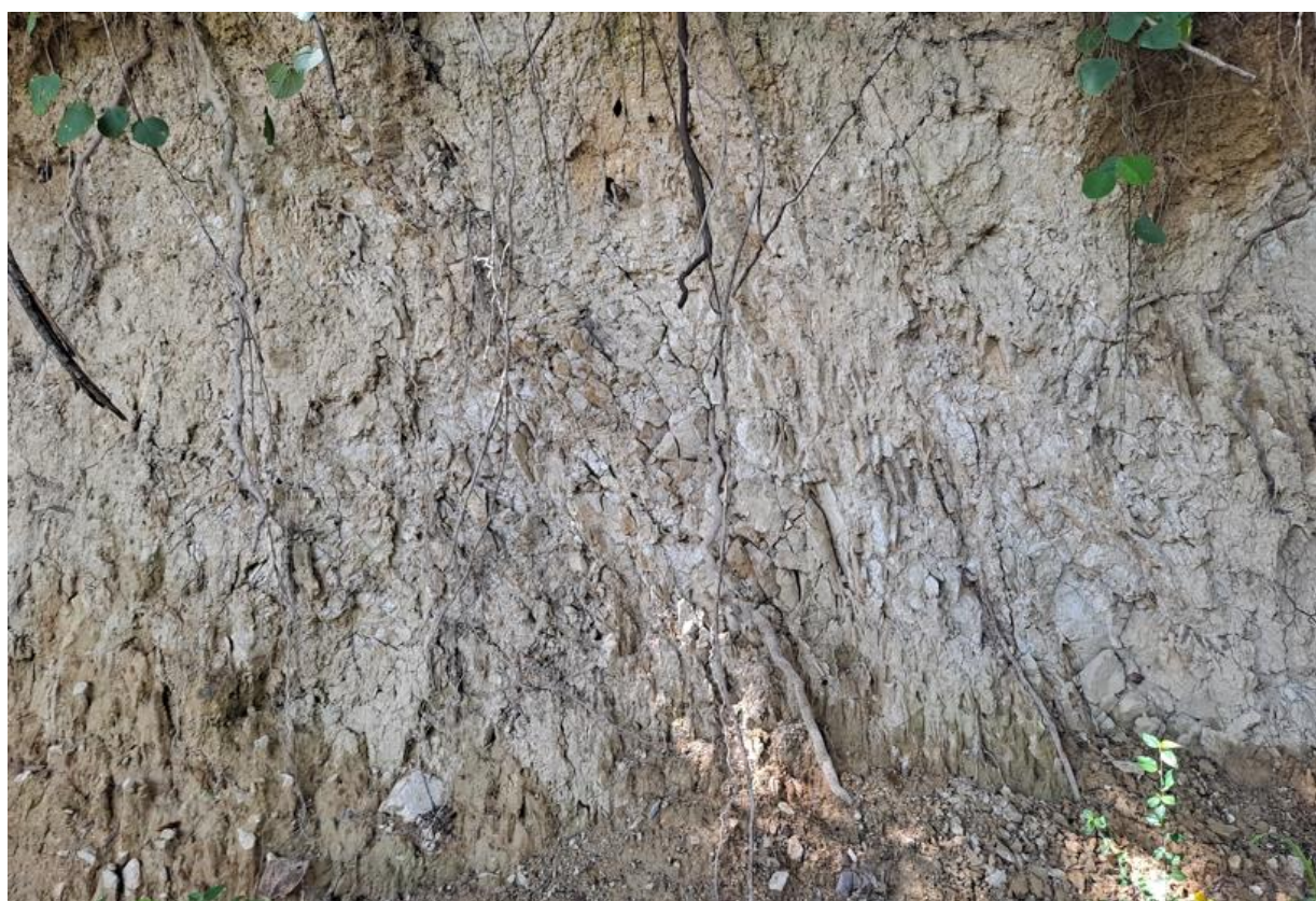
Figura N° 14. Afloramiento de margas sin estructura visible debido a la fracturación y plegamiento intenso vista durante la visita del 09/10/2025
